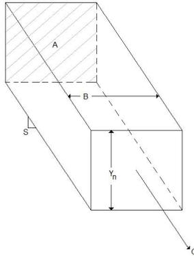
15. La figura siguiente muestra un canal abierto de dimensiones constantes con un área transversal  $A$ . Bajo condiciones de flujo uniforme, se cumple la siguiente relación basada en la ecuación de Manning (Ingeniería de fluidos):
