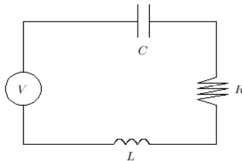
Suponiendo que  $L$ ,  $R$  y  $C$  son constantes, mediante física elemental se sabe que el voltaje generado  $V(t)$  se consume en todos los elementos del circuito, es decir,
