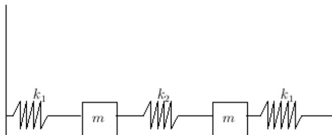
determinar las ecuaciones de movimiento que se producen al desplazar la masa de la izquierda  $75\text{ mm}$  hacia la izquierda para luego soltarla. Se supone que no hay resistencia con el suelo y que  $m = 15\text{ kg}$ ,  $k_1 = 0.8\text{ N/mm}$  y  $k_2 = 0.9\text{ N/mm}$ . Determinar las posiciones de los cuerpos a los 5 segundos de soltar el cuerpo.
