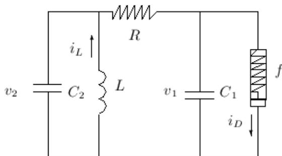
donde se introduce un elemento llamado diodo de Chua que se modeliza por una función lineal a trozos (ver [GSCO]). Las ecuaciones diferenciales que describen el circuito vienen dadas por
