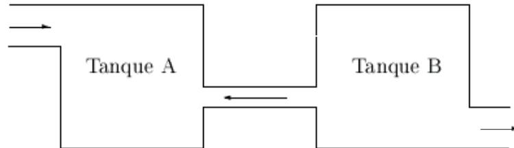
11. Un edificio consta de dos zonas A y B. Solamente la zona A es calentada por un calefactor, que genera 80.000 kilocalorias por hora. La capacidad calorífica de la zona A es de  $1/4$  de grado Celsius por cada 1000 kilocalorias. Las constantes de transferencia de calor son 4 horas entre la zona A y el exterior, 5 horas entre la zona B y el exterior y 3 horas entre las dos zonas. Si la temperatura exterior es de 0 grados Centígrados, ¿a qué temperatura puede llegar a enfriarse la zona B?
