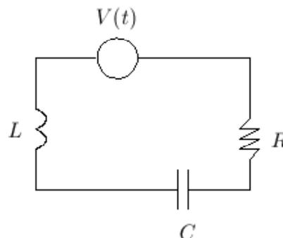
Calcular la intensidad de corriente que pasa por los cables de dicho circuito en los siguientes casos, suponiendo que el circuito está descargado ( $i(0) = i'(0) = 0$ ):
