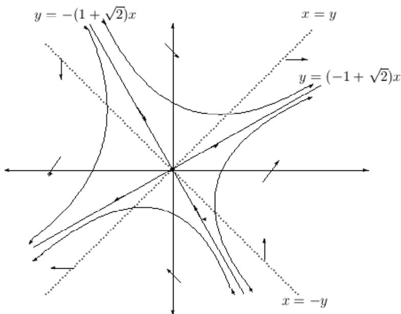
Nótese que la dirección temporal en las órbitas está indicada por una flecha. Esa dirección viene marcada por la dirección y sentido del vector velocidad obtenido previamente: según la región, determinada por las isoclinas, en la que la órbita esté se tendrá una dirección. Nótese además que las rectas  $y = -(1 + \sqrt{2})x$  e  $y = (-1 + \sqrt{2})x$  contienen 3 órbitas: dos semirrectas divididas por la órbita degenerada formada por el punto crítico  $(0, 0)$ .
