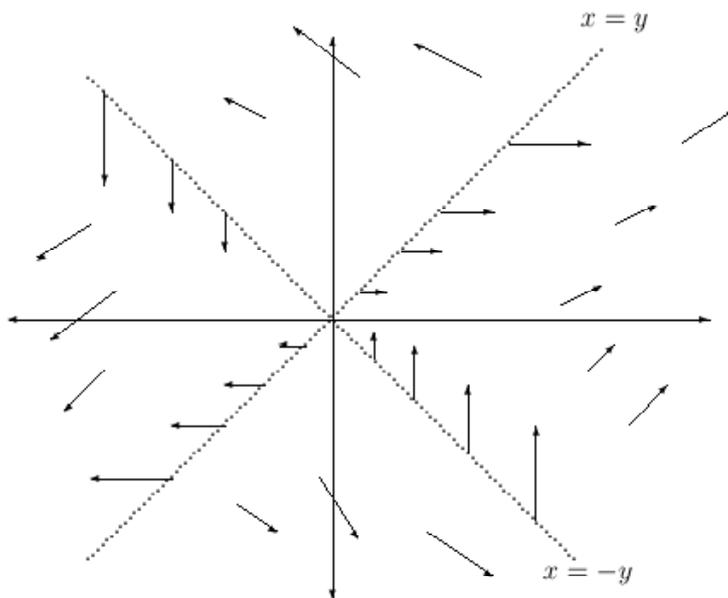
Notar que el punto  $(0,0)$ , único punto crítico del sistema se obtiene como intersección de las dos rectas isoclinas. ■
