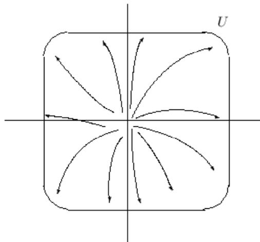
Obsérvese como en el dibujo las rectas del sistema linealizado son deformadas y transformadas en curvas. Además, como la orientación temporal se conserva, la estabilidad del punto crítico puede estudiarse a partir del sistema no linealizado. Así, el punto crítico  $(0, 0)$  es inestable para el sistema no linealizado dado que es inestable para el sistema linealizado.
