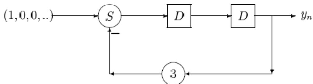
19. Calcular el comportamiento asintótico (límite cuando  $n$  tiende a infinito) de la solución de los siguientes circuitos digitales:
