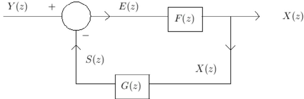
En este sistema buscamos obtener la solución transformada  $Y(z)$  mediante el siguiente proceso. Inicialmente obtenemos  $X(z)$  a partir del sistema dado por la función de transferencia  $F(z)$ . La función  $X(z)$  se transforma en el sistema dado por  $G(z)$  obteniéndose  $S(z)$ . Finalmente  $E(z) = Y(z) - S(z)$ , que a su vez vuelve a ser utilizada para obtener una nueva  $X(z)$  mediante el proceso dado por la función de transferencia  $F(z)$ . Buscamos la función de transferencia
