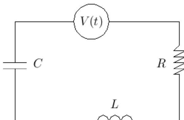
donde la inductancia  $L$ , la resistencia  $R$  y la capacidad de condensador  $C$  se consideran constantes. Se tiene entonces que la carga  $q(t)$  que circula por el circuito está dada por la ecuación
